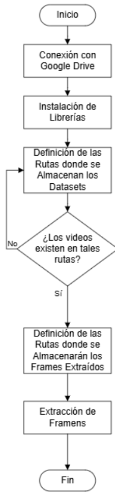
Figura 9. Diagrama de flujo de la configuración inicial.
